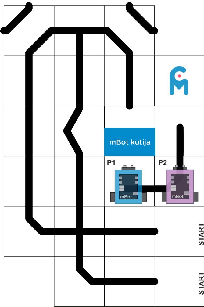
Nakon toga plavi robot nastavlja praćenjem linije prema prepreci na stazi. Kad nađe na prepreku prepoznavši je korištenjem ultrazvučnog senzora, zaustavlja se na jednu sekundu i dok stoji ispred nje svjetli crvenom bojom. Nakon toga ponovno mijenja boju u zelenu, skrene lijevo, nađe crnu liniju te je nastavi pratiti do njenog kraja. Kada dođe do kraja linije parkira se na polje P1 iza prepreke da bude u poziciji kako je prikazano na drugoj slici.
